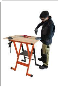
Posición plataforma de trabajo: plataforma con 4 puntos de apoyo antideslizantes. Altura de trabajo: 90 cm. Capacidad: 50 kg.
